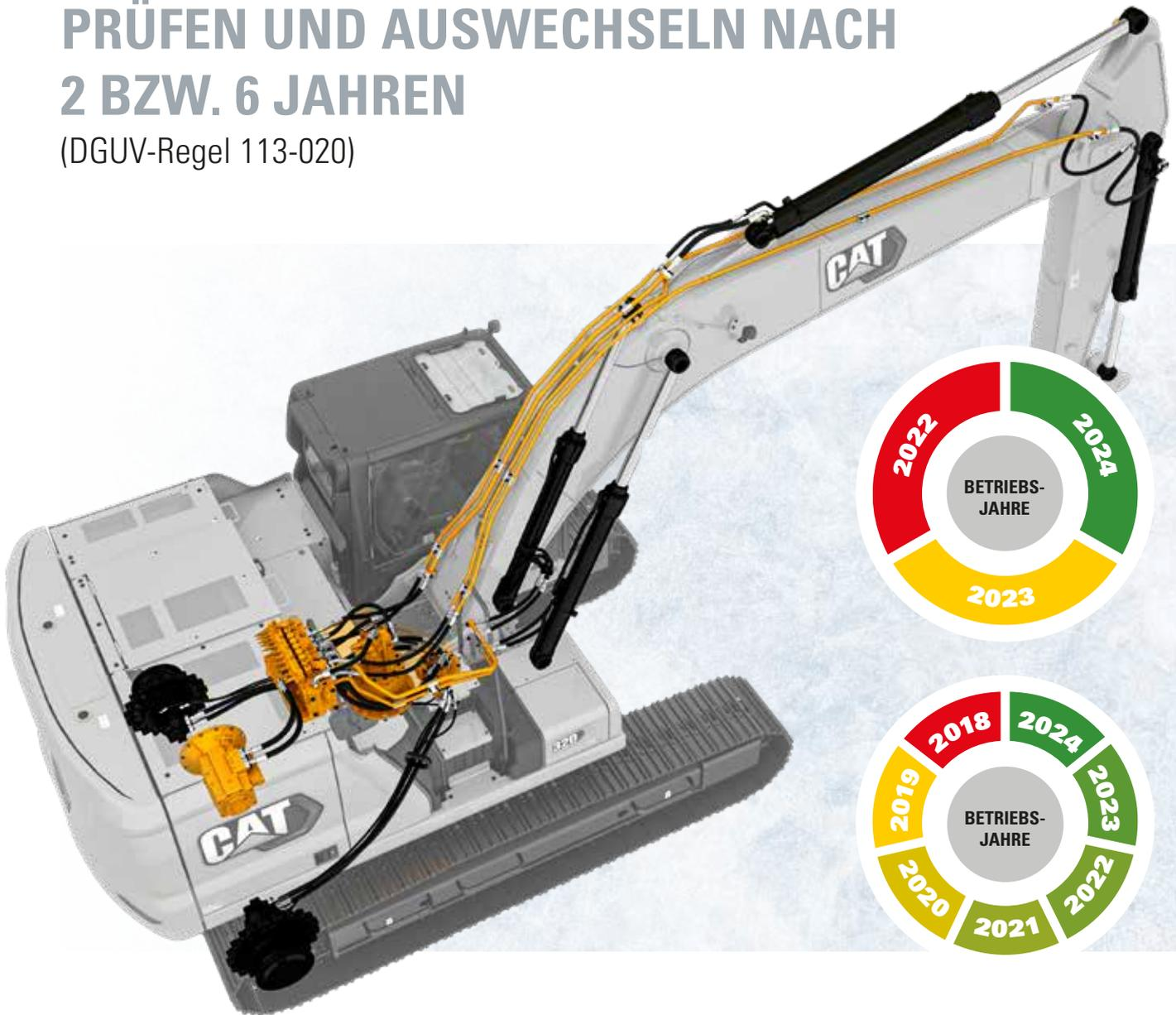
Hydraulikschläuche sind Verschleißteile unter Hochdruck. Deshalb müssen sie regelmäßig untersucht und bei Bedarf fachmännisch instandgesetzt oder getauscht werden!
