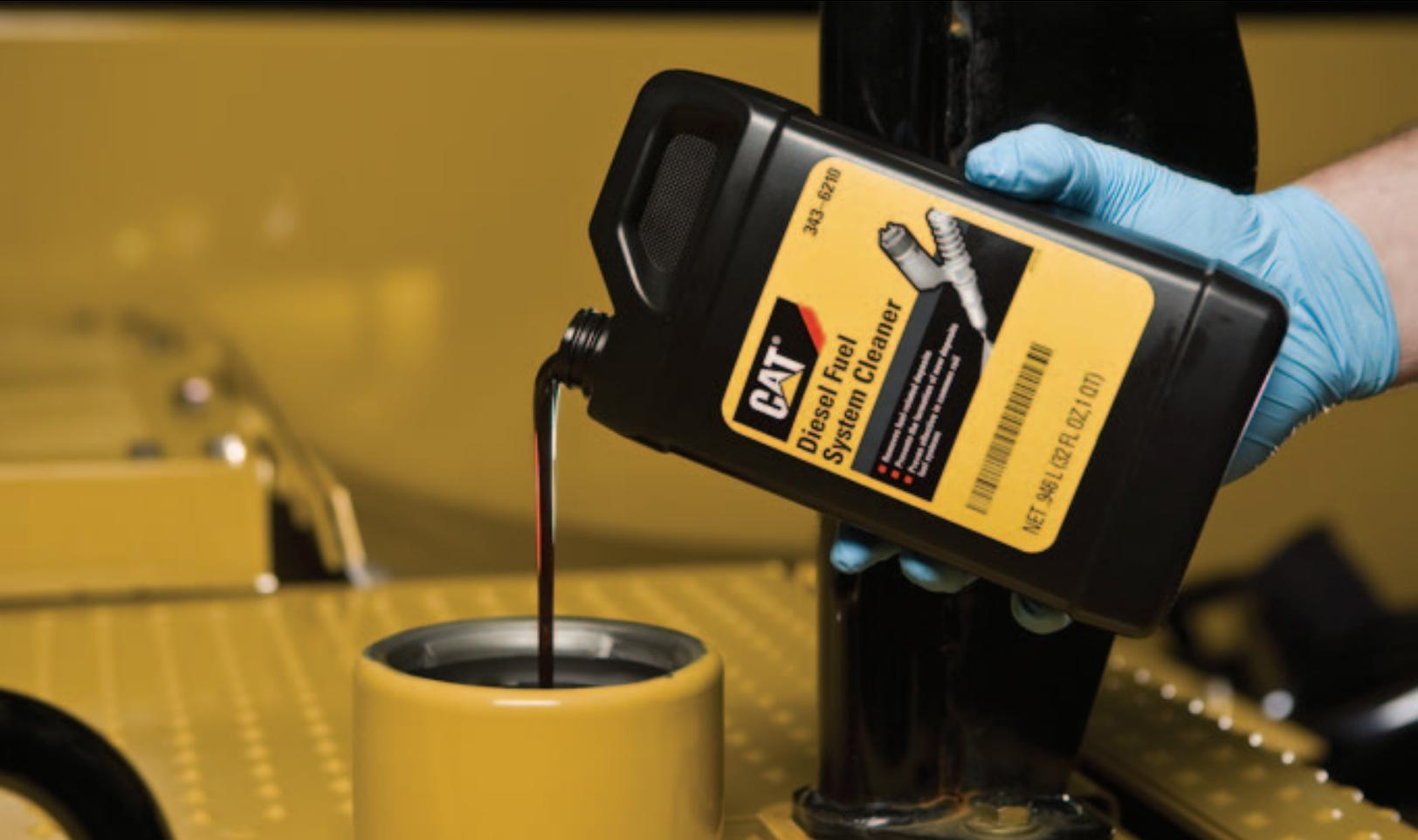
Der neue Reiniger für Dieselkraftstoffsysteme von Caterpillar (Bestellnummer 343-6210) ist ein hervorragendes Reinigungsprodukt speziell für Motoren mit Problemen wie Leistungsverlust, gesteigertem Kraftstoffverbrauch oder schwarzem Rauch wegen Ablagerungen von Kraftstoff in den Einspritzdüsen. Er entfernt Ablagerungen, die sich im Kraftstoffsystem bilden und dessen maximale Leistung behindern.
