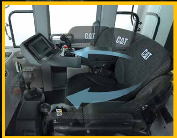
Fahrersitz für mehr Komfort und bessere Sicht um 180° drehbar
