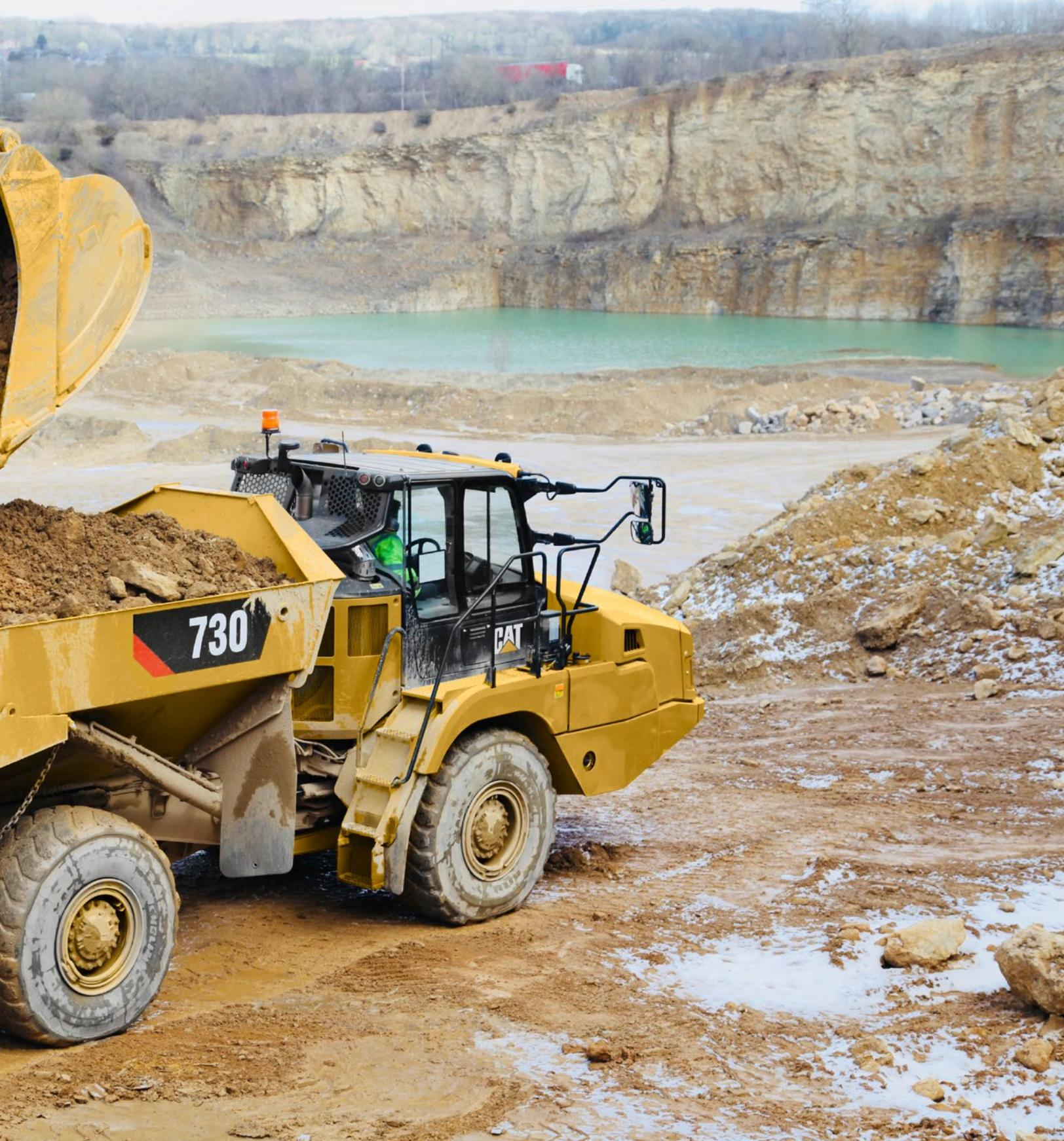
**Der Cat 730 mit einem Fassungsvermögen von 17,5 m<sup>3</sup> bzw. 28 Tonnen bietet nachgewiesene Zuverlässigkeit und Langlebigkeit, hohe Leistung und Produktivität sowie eine erstklassige neue Fahrerkabine für hohen Fahrerkomfort und Bedienerfreundlichkeit.**
