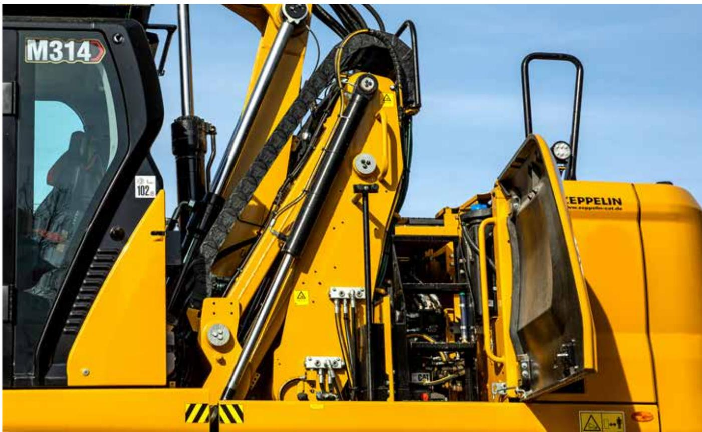
Die täglichen Wartungskontrollen können vollständig vom Boden aus durchgeführt werden, wodurch die Wartung schneller, einfacher und vor allem sicherer wird.
