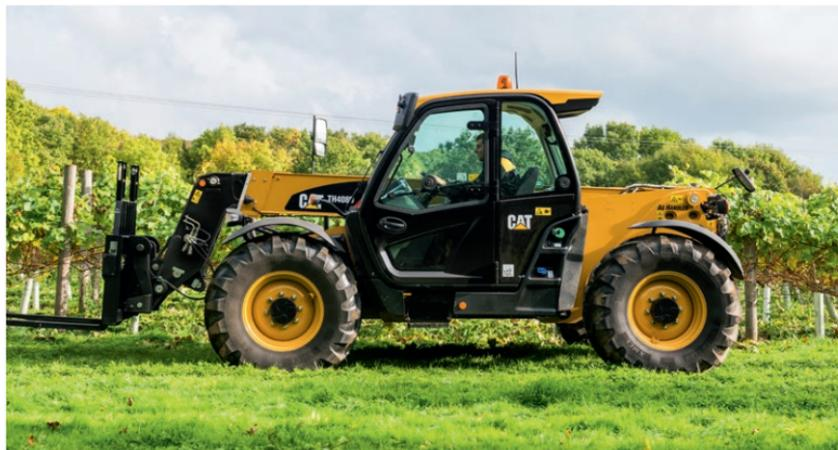
Die Typen TH357D bis TH3510D mit LoF-Zulassung sind mit einem zweiteiligen Ausleger (TH3510 dreiteilig) ausgestattet und eignen sich besonders für Einsätze im Agrarbereich, dafür sind diese Geräte auch mit speziellen Ausrüstungen lieferbar.
