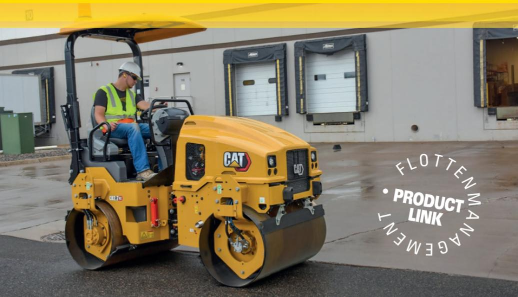
Die Typen in der Klasse 1 bis 3 Tonnen mit verbrauchoptimiertem Cat Motor sind besonders robuste und vielseitige Maschinen, die sowohl bei Asphaltreparaturen als auch auf größeren Flächen hohe Leistungsfähigkeit beweisen. Mit der zentralen Kranöse sind die Maschinen schnell und sicher zu verladen, der umklappbare ROPS-Bügel ermöglicht den Einsatz auch bei eingeschränkter Durchfahrts Höhe. Vorbildlich auch die hohe Wartungs- und Servicefreundlichkeit.
