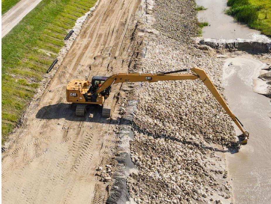
Die Cat Typen 340 und 352 gibt es auch als LRE-Ausführung (Long Reach Excavation) mit etwas kürzerer Arbeitsausrüstung, HD-Breitspur-Unterrahmen und mehr Kontergewicht, aber erweiterten Einsatzmöglichkeiten für Anbaugeräte und immer noch rund 66 Prozent Grabkraft im Vergleich mit der Standardmaschine.
