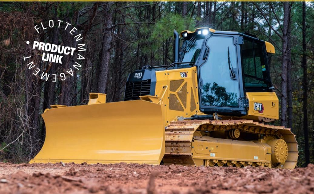
Der hydrostatische Fahrtrieb der Cat Kettendozer mit klassischem ovalem Laufwerk zeichnet sich aus durch hohe Wendigkeit bis hin zum Drehen auf der Stelle. Das Konzept erfüllt die Anforderungen seiner Klasse perfekt: ausgezeichnete Lenkeigenschaften ohne Zugkraftunterbrechung in Kurven, hohe Arbeitsgeschwindigkeit und einfache Bedienung mit vorgesteuertem, drehbarem Joystick, direkt am Sitz montiert für mehr Komfort und reduzierte Vibrationsbelastung.
