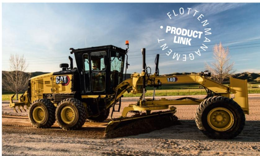
Bei allen Cat Gradern schaltet das elektronisch gesteuerte Getriebe schnell und sanft durch alle Gänge und bietet eine enorm hohe Schubkraft. Bis zum 160 sind alle Grader mit Allradantrieb verfügbar und können durch Frontschild und weitere Optionen an jeden Einsatz angepasst werden. Für hohe Flexibilität können verschiedene Typen für den Straßenverkehr zugelassen werden.
