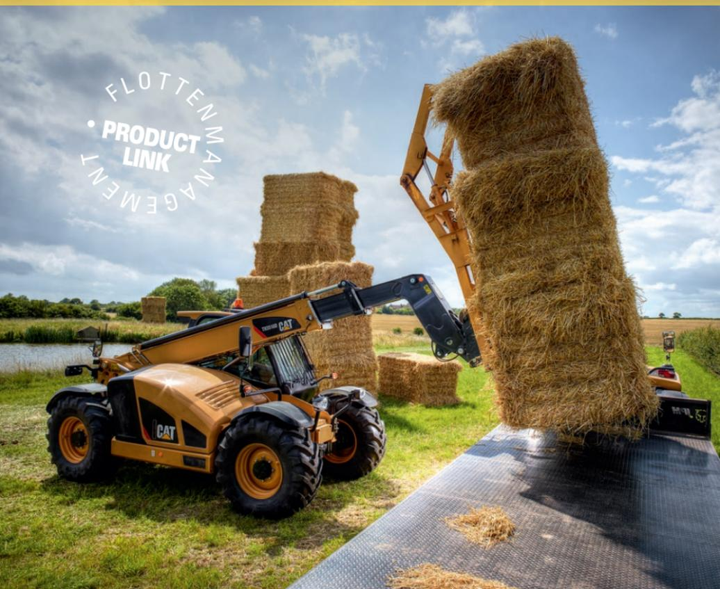
Cat Telehandler sind mit Allradlenkung und Allradantrieb besonders wendig und geländegängig. Mit Parallelhub und der großen Hubhöhe und Reichweite eignen sich diese Maschinen für viele Stapel- und Montagearbeiten sowie für den universellen Einsatz in der Landwirtschaft. Zahlreiche Anbaugeräte, wie Ballenklammer oder Kranlasthaken machen sie zu leistungsstarken Allroundern. Alle Telehandler sind mit abgasarmen und sparsamen Motoren ausgestattet.
