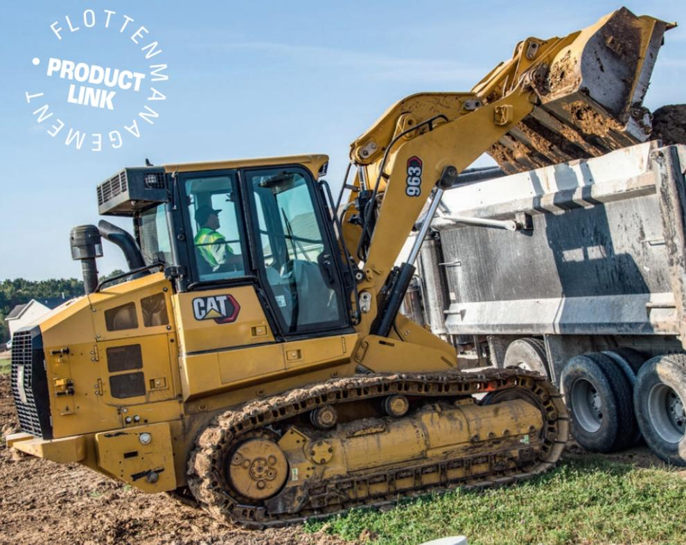
Vor allem beim Arbeiten auf wenig tragfähigen Böden zeigt der Kettenlader seine Vorteile. Für feinfühliges und wendiges Lenkverhalten und hohes Beschleunigungsvermögen sind alle Cat Kettenlader mit hydrostatischem Fahrtrieb ausgestattet. Das hochwertige Laufwerk garantiert ruhigen Lauf und lange Lebensdauer. Die elektrohydraulische Vorsteuerung erlaubt die bequeme Voreinstellung der Schaufelendstellungen für Heben, Senken und Einstechwinkel direkt vom Fahrersitz aus.
