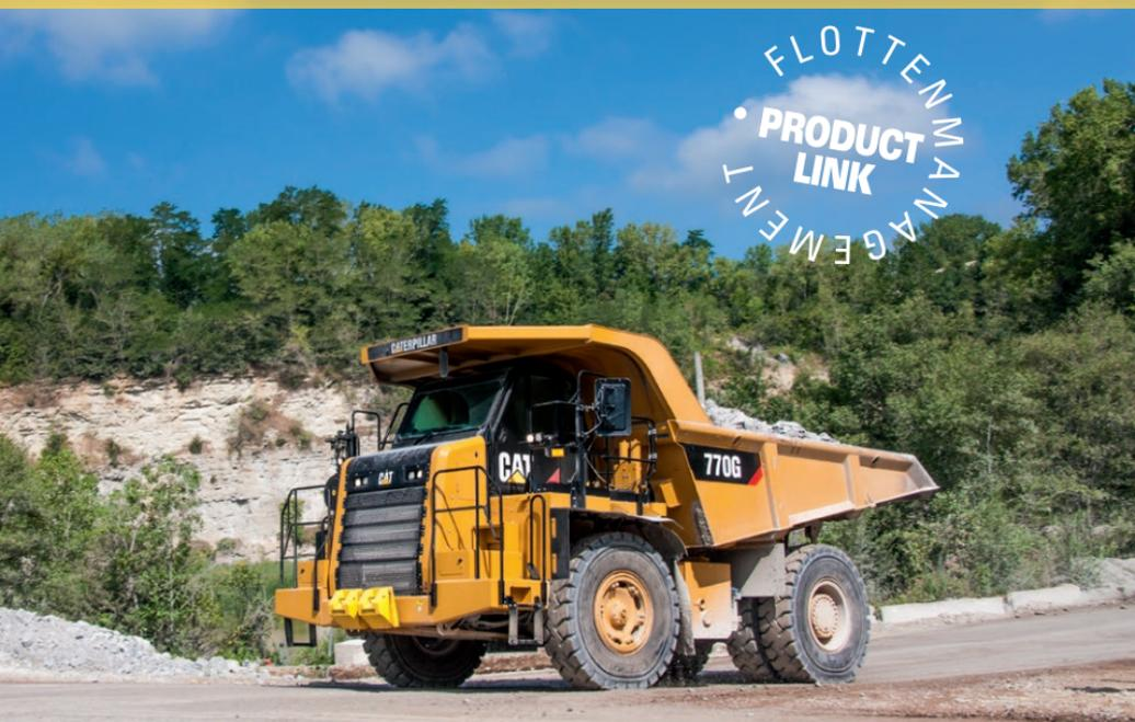
Die Caterpillar Muldenkipper zählen zu den Marktführern in der deutschen Gewinnungs- und Tagebauindustrie. Hohe Zuverlässigkeit und Produktivität sowie Effizienz und Sicherheit zeichnen diese Maschinen aus. Ein intelligenter und sorgfältig abgestimmter Antriebsstrang bestehend aus effizientem Cat ACERT Motor, Drehmomentwandler mit Überbrückungskupplung und ein hochmodernes Getriebe ermöglichen den Transport von Rohstoffen zu niedrigsten Kosten pro Tonne.
