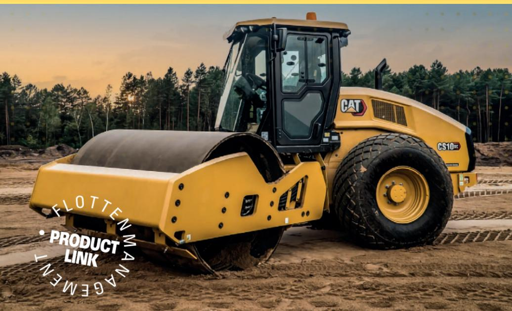
Die Cat Erdbauwalzen mit Glattmantel- (CS) und Stampffußbandage (CP) der Serie B sind mit Doppelpumpenantrieb ausgestattet, während die GC- Maschinen über eine Einzelpumpe angetrieben werden. Bei allen Typen erfolgt der Antrieb über Hinterachse und Bandage. Durch die beiden separaten Antriebspumpen profitieren die Maschinen der B-Serie von exzellenter Steigfähigkeit im Hangbetrieb und sehr guten Lenkeigenschaften auf feuchtem Untergrund.
