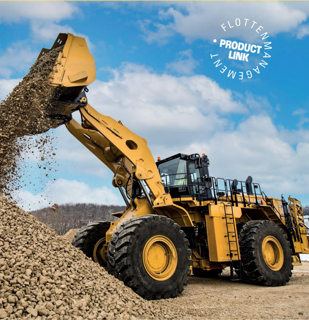
Alle Cat Großradlader sind mit komfortablen und modernen Fahrerkabinen ausgestattet. Elektrisch vorgesteuerte Bedienhebel und ein moderner Maschinenmonitor für zahlreiche Einstellungen ermöglichen eine hohe und effiziente Produktion über den gesamten Arbeitstag. Das optionale Cat Produktions-Management-System mit integrierter Waage bei allen Typen sorgt für optimale Ausladung der Transportfahrzeuge.
