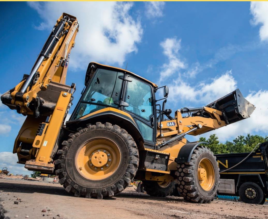
Cat Baggerlader mit Allradantrieb sind mobile Grab- und Ladegeräte mit sehr universellen Eigenschaften. Alle Modelle sind mit einem vielseitigen und kräftigen Hubgerüst ausgestattet, das hohe Ausbrechkräfte im Erdbau bietet und bei Arbeiten mit der Palettengabel die Last exakt parallel führt. Der Heckbagger mit teleskopierbarem Stiel ist auf einem Schiebeschlitten angeordnet – für ein erweitertes Arbeitsfeld und für das Grabenziehen außerhalb der Spurmitte.
