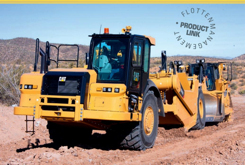
Schürfüge, früher bei großen Erdbewegungen oft die dominierenden Baumaschinen, werden heute in Deutschland kaum noch eingesetzt. Dennoch bilden diese Maschinen, passende Einsatzbedingungen vorausgesetzt, die leistungsstärksten und effektivsten Systeme in der schweren Erdbewegung.
