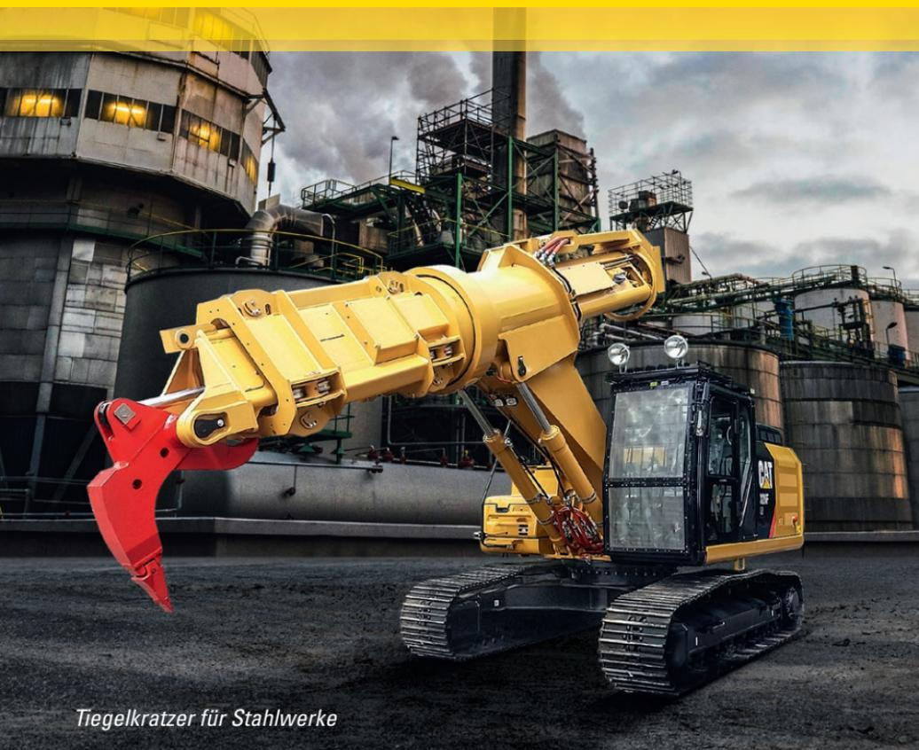
*Tiegelkratzer für Stahlwerke*
