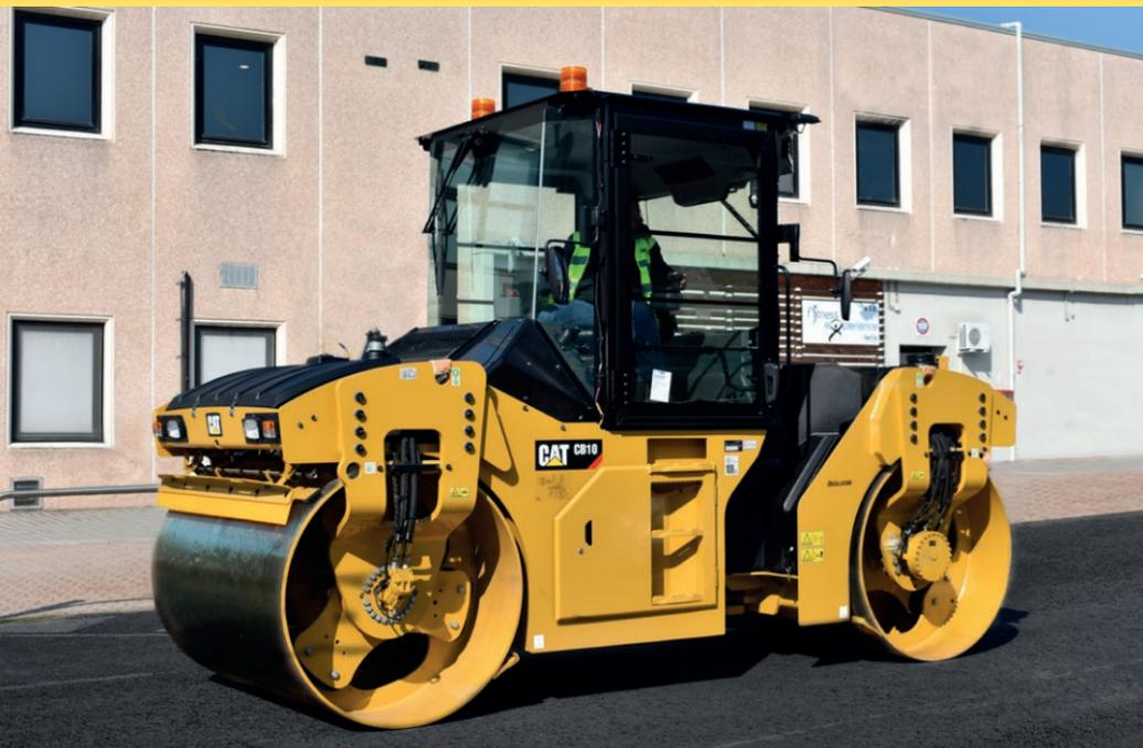
In der Klasse 8 bis 10 Tonnen sind die Tandemwalzen mit Stufe-IV-Motoren von Cat ausgestattet. Die automatische Geschwindigkeitsregelung, der Eco-Mode und die ergonomisch gestaltete Kabine bieten effizienten, kraftstoffsparenden Einsatz und vorbildlichen Komfort für den Bediener, der außerdem ausgezeichnete Sicht auf Bandagenfläche und Bandagenkanten genießt. Alle Asphaltwalzen sind mit flächendeckender Verdichtungskontrolle speziell für Asphalt lieferbar.
