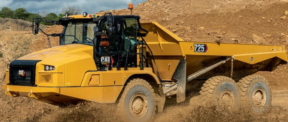
Die knickgelenkten Muldenkipper von Caterpillar sind konstruiert für den Materialtransport in härtestem Gelände. Bei der Entwicklung der neuesten Generation wurde Wert auf eine sehr einfache und intuitive Bedienung gelegt. Die Fahrerkabine bietet Komfort auf höchstem Niveau, sie ist die größte am Markt.
