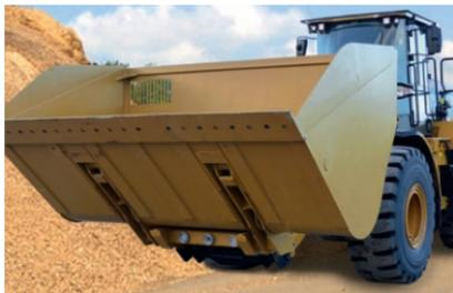
*Schaufelintegriertes Kamerasystem nach ISO 5006*
