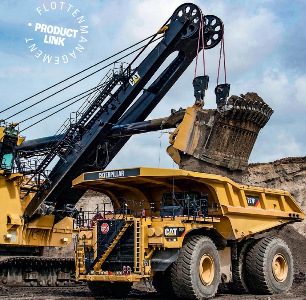
Die Cat Muldenkipper in der Nutzlastklasse 100 bis 400 Tonnen finden weltweit Einsatz beim Abbau von Rohstoffen im Berg- und Tagebau. Alle Typen sind mit robusten und sparsamen Cat Motoren ausgestattet, die zusammen mit vollautomatischen Getrieben und einem elektronisch gesteuerten Antriebsstrang mit Schlupfregelung jederzeit für kraftvollen Vortrieb und komfortable Schaltvorgänge sorgen.
