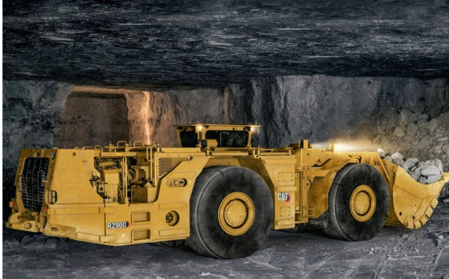
Für den Antrieb des Cat R1700 bzw. des Cat R2900 steht ein verbrauchsoptimierter Cat C13 bzw. Cat C15 Acert-Turbodiesel mit Ladeluftkühler und elektronischer Einspritzung zur Verfügung. Mit der Cat Joystick-Lenkung und der optionalen Schaufeldämpfung Ride Control für mehr Tempo und Komfort bieten die Maschinen typische Merkmale der großen Cat Radlader im Einsatz über Tage.
