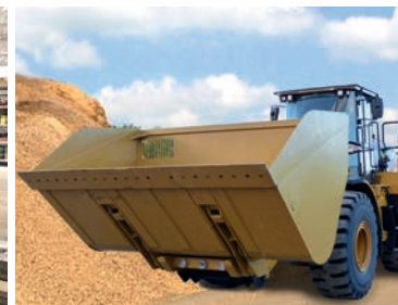
Schaufelintegriertes Kamerasystem nach ISO 5006
