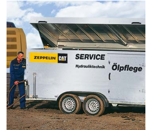
Ölpflegeanhänger: reinigt kontaminierte Hydraulik-Ölkreisläufe auf der Baustelle
