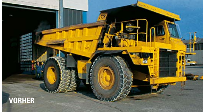
VORHER Elf Jahre war dieser Cat 773B im Einsatz, für insgesamt 21.700 Betriebsstunden. Der Betreiber entschied sich für ein Certified Rebuild, das deutlich günstiger als eine Neuanschaffung war.
