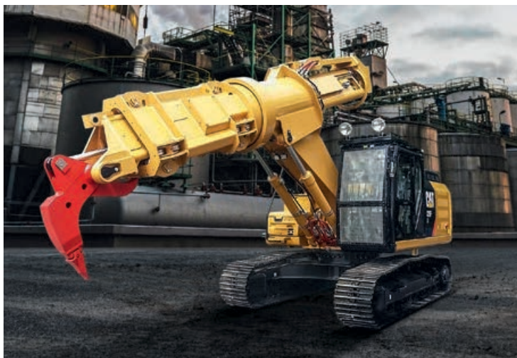
Tiegelkratzer für Stahlwerke
