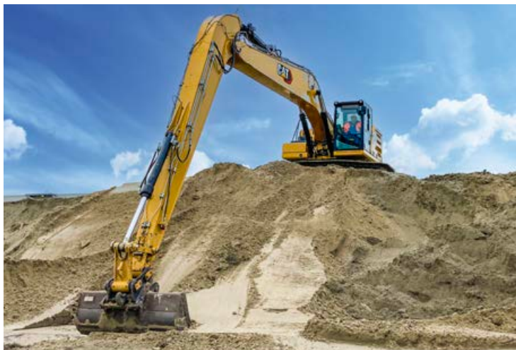
Long-Reach-Ausleger für Kettenbagger
