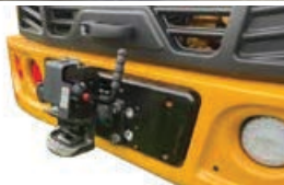
Anhängekupplungen für Radlader und Mobilbagger
