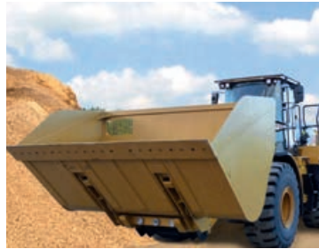
Schaufelintegriertes Kamerasystem nach ISO 5006
