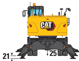
Fahrwerk mit 2 Paar Abstützpratten
