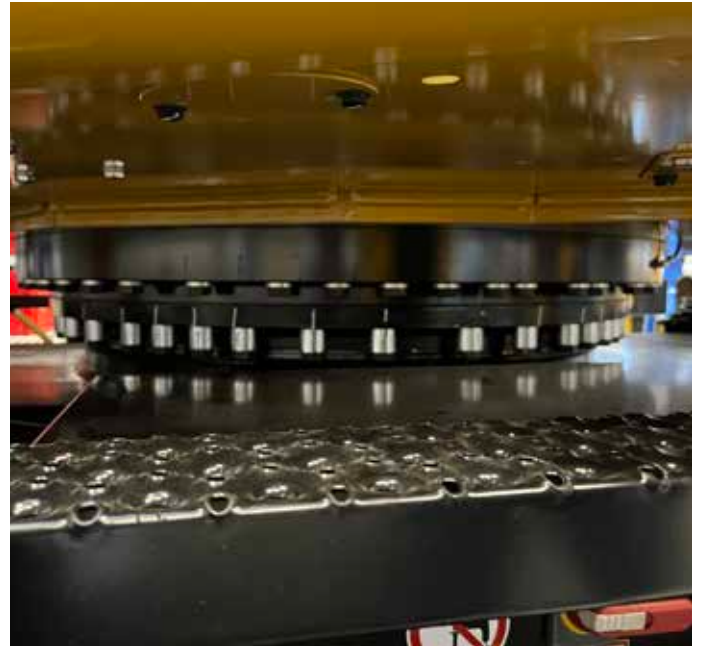
Die elektrische Leistung gelangt über einen großzügig dimensionierten und beheizten Schleifringkörper in den Oberwagen.
