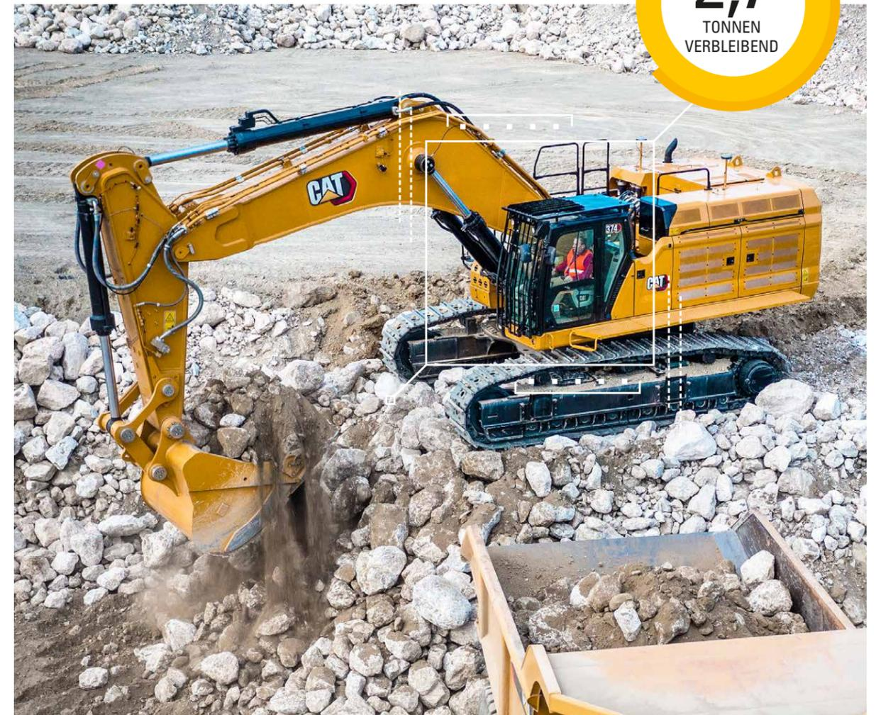
Das Cat Payload-System berechnet das Materialgewicht im laufenden Betrieb, indem es Daten aus den Sensoren nutzt, die die Löffelposition und den Hydraulikdruck messen.
