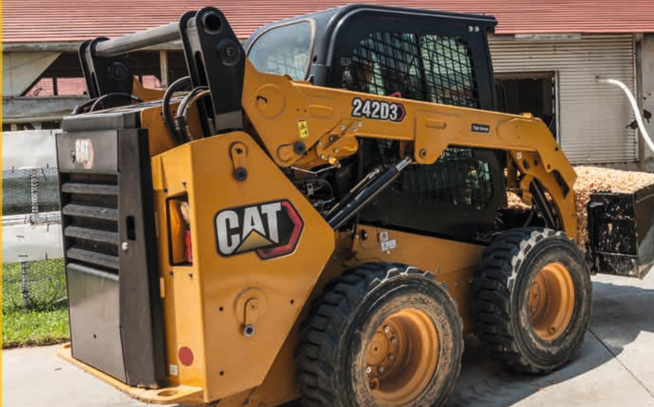
Cat Kompaktlader bilden eine äußerst vielseitig einsetzbare und robust konstruierte Maschinengruppe. Leistungsstarke Antriebs- und Hydrauliksysteme verhelfen ihnen zu imponierender Traktion und Leistungsstärke. Mit der ungewöhnlichen Wendigkeit bis zum Drehen auf der Stelle bewähren sich diese Maschinen besonders unter beengten Platzverhältnissen, z. B. in Ställen.
