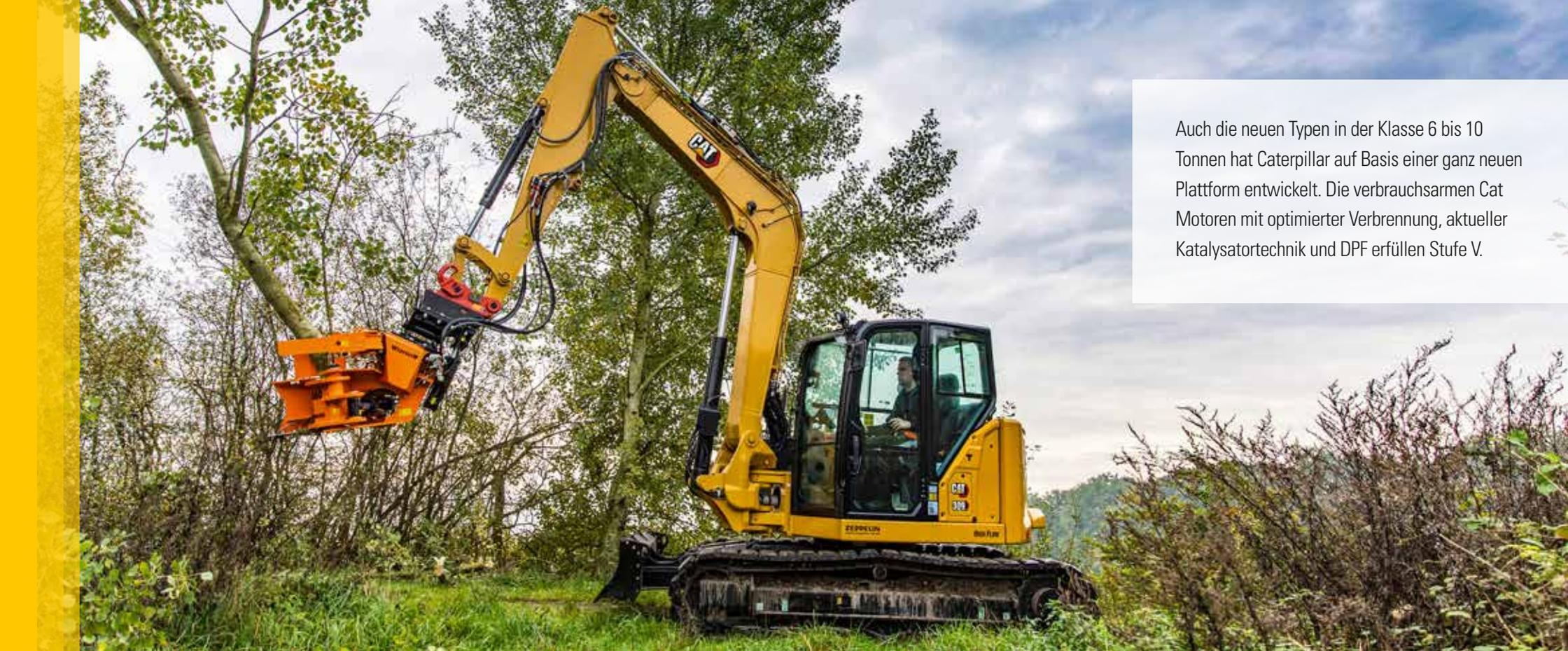
Auch die neuen Typen in der Klasse 6 bis 10 Tonnen hat Caterpillar auf Basis einer ganz neuen Plattform entwickelt. Die verbrauchsarmen Cat Motoren mit optimierter Verbrennung, aktueller Katalysatortechnik und DPF erfüllen Stufe V.
